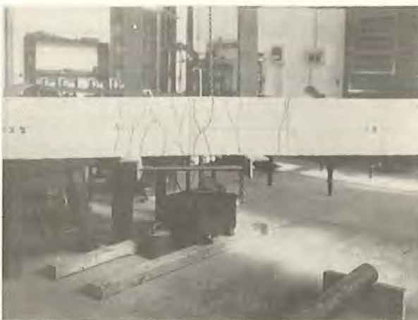
67) Kamstålsarmeret betonbjælke efter udmattelsesbrud.
